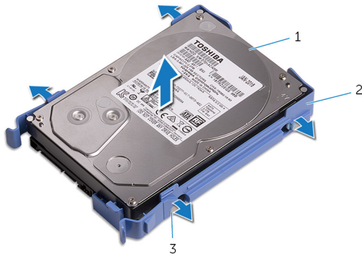
Afbeelding 14. De harde schijf uit de beugel verwijderen.
