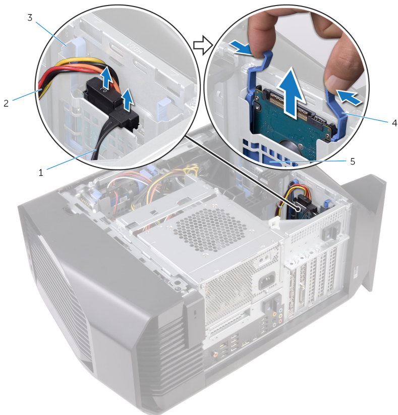
Afbeelding 15. De harde schijf verwijderen
