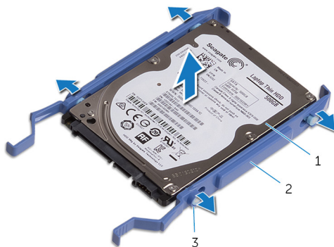
Afbeelding 16. De harde schijf van de beugel verwijderen
